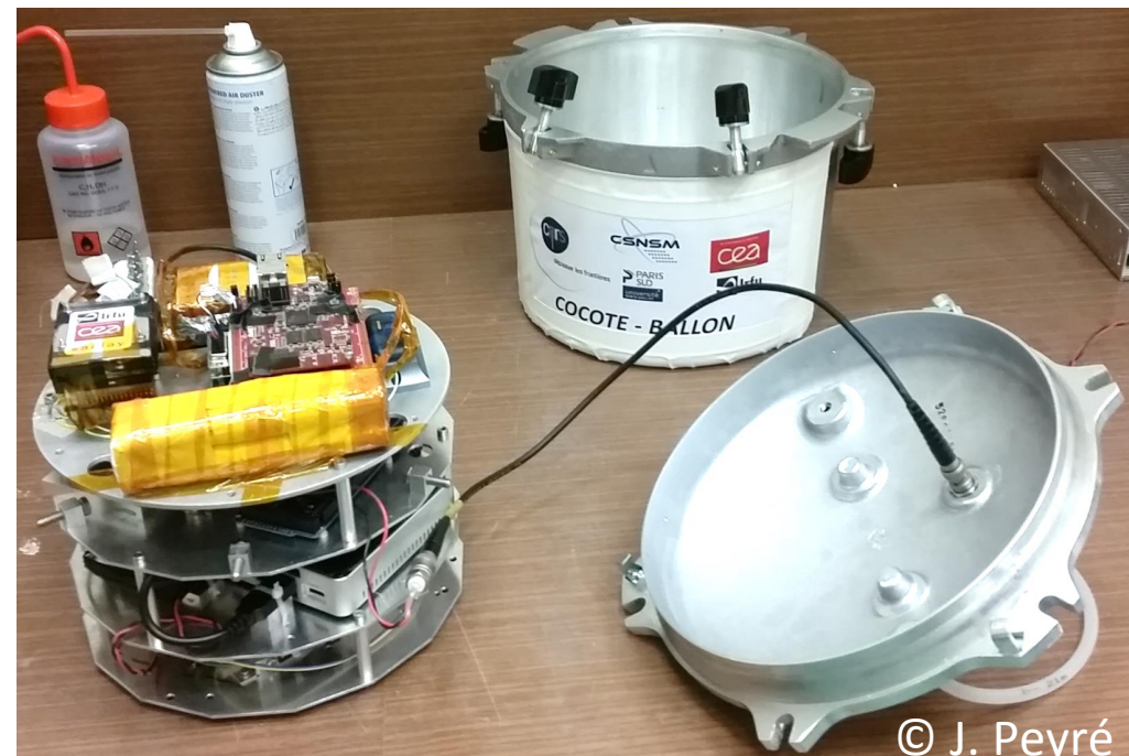
Absorbeur : Scintillateur en \text{CeBr}_3 (CNRS)
