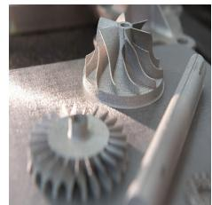
adapté un alliage d'acier sur mesure pour qu'il soit compatible avec la technologie d'impression 3D par fusion sur lit de poudre. La fabrication additive a des répercussions dans le secteur militaire , notamment sur toute la partie logistique : la technologie offre aujourd'hui des moyens plus efficaces pour produire des pièces détachées à la demande, améliorant alors les délais de fabrication et les flux d'approvisionnement.
